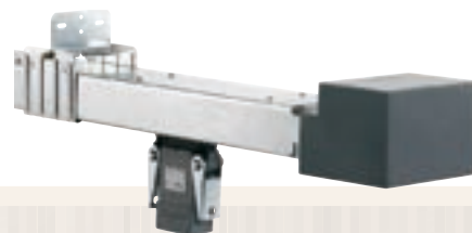
ТРОЛЛЕЙНЫЕ ШИНОПРОВОДЫ СЕРИИ TS ОТ 63 А ДО 250 А ТРЕХФАЗНЫЕ (3L+N+PE)
