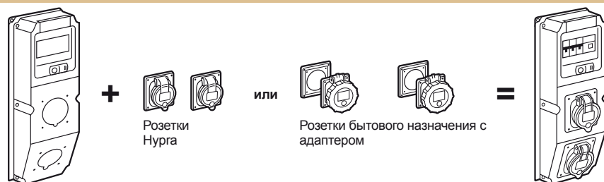
Щиток с отверстиями
